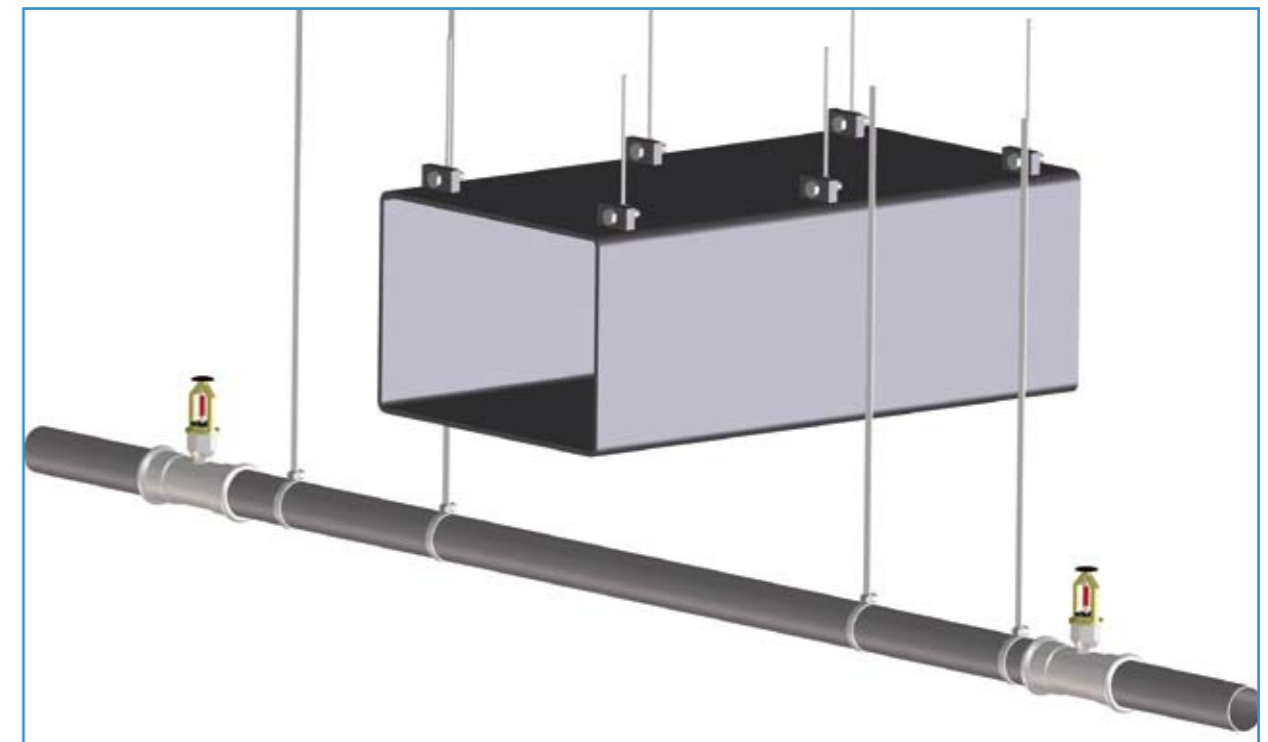
Illustrasjon 4: Plassering av klammer i tilfellet av overkryssning (ventilasjonssjakt)
